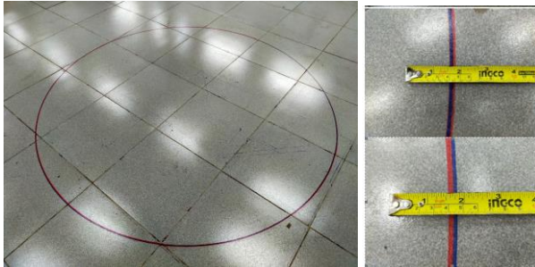
Hình 5.14: Kiểm tra độ chính xác với quỹ đạo hình tròn
